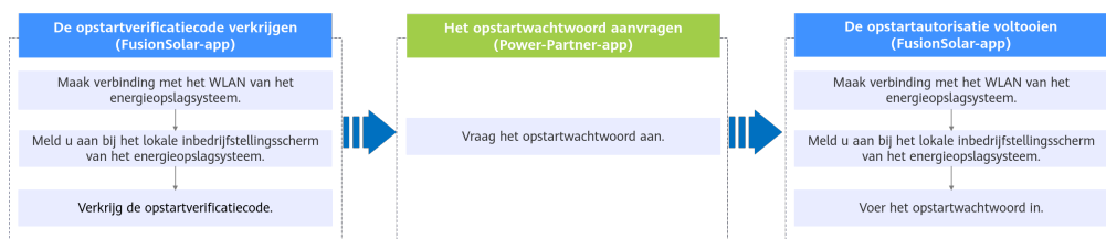
Afbeelding9-2 Opstartautorisatieprocedure voor het energieopslagsysteem
